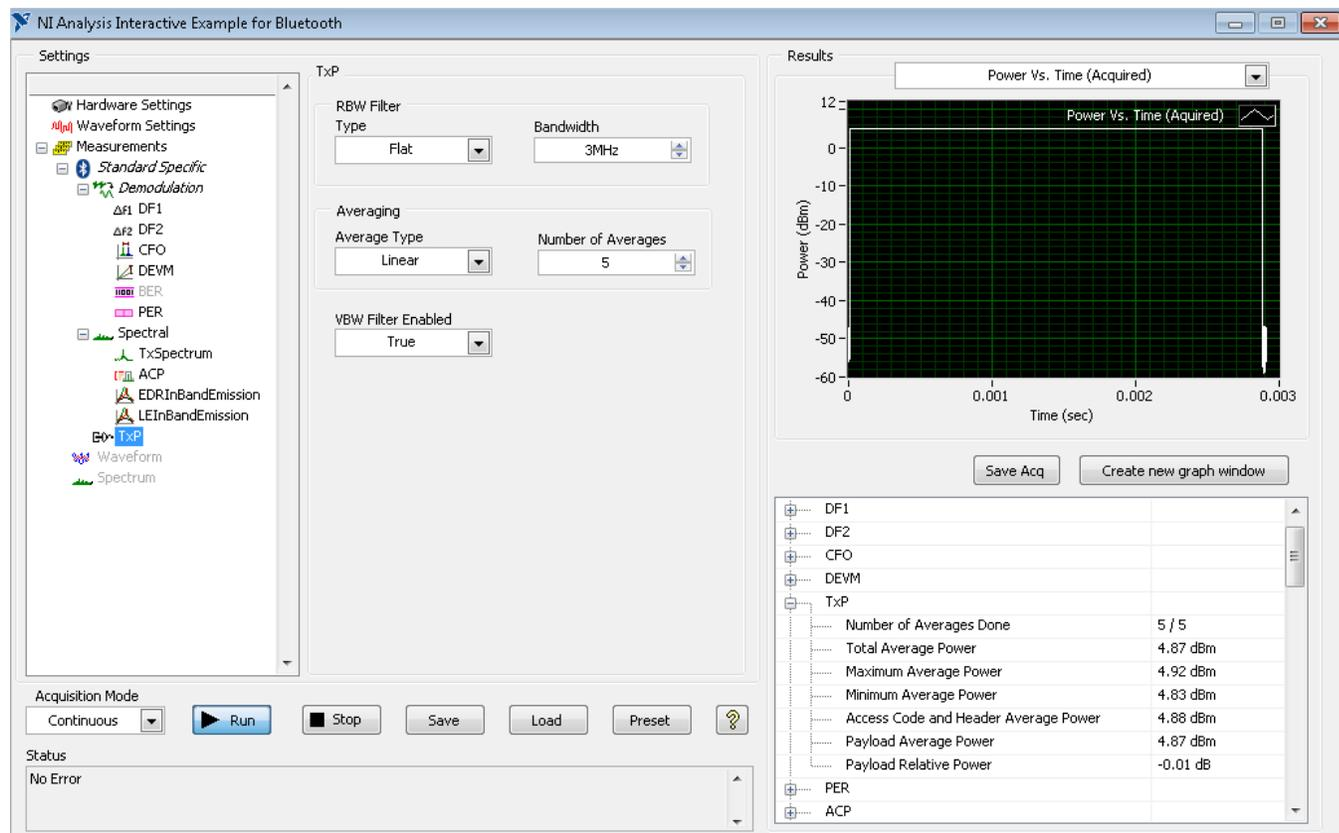
**Figure 27. Output Power Measurement (DH5 packet)**
