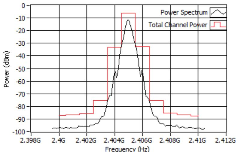
Figure 64 ACP Measurement of a DH1 Packet-Type Bluetooth Signal
